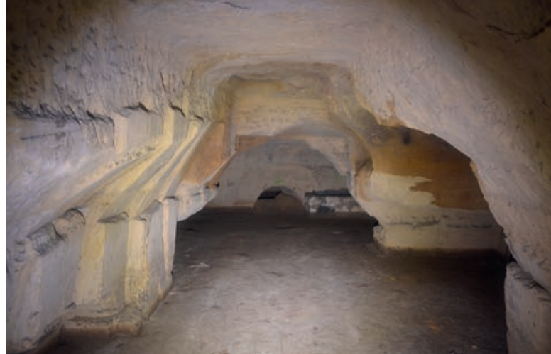
▲ AFBEELDING 23: Dit is een voorbeeld waar het versmallen van de pilaar hoort bij de ontginningsmethode en er dus geen sprake is van roofbouw.
